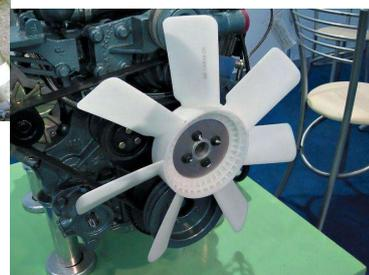
Двигатель с принудительным воздушным охлаждением
